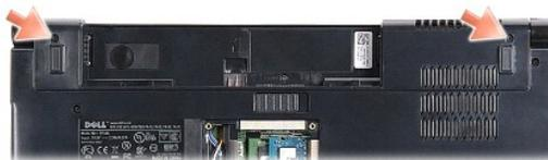
6. Extraiga la cubierta del control central (consulte [Extracción de la cubierta del control central](#)).
